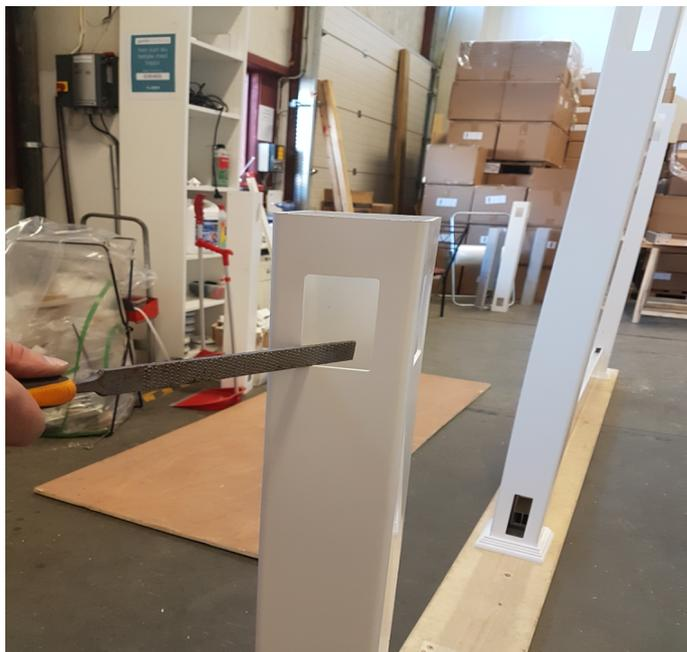
1. Ved vinkler større/mindre enn 90 grader er det flere måter å gjøre det. Man kan montere stolper i rett vinkel og så file på sidene i hullene til overligger/underligger til man får den vinkelen man trenger. Man kan og montere braketter/stolpe i vinkel og så få en rett vinkel.
